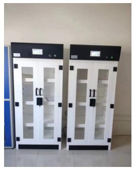
补风式通风柜:对于有空气调节系统的实验室或洁净实验室,采用这种通风柜是很理想的,既节省了能量,又不影响室内的气流组织。自然通风式通风柜:优点是不耗电,能日夜连续换气,有利于室内换气;无噪声和振动;由于没有机械设备,容易保养;构造简单,造价低廉。但它的使用受一定条件限制,凡毒性较高和不产生热量的实验,都不宜采用,有的房间,在夏季也不宜使用。项抽式通风柜:这种通风柜的特点是结构简单、制造方便,适合有热量产生的场合。狭缝式通风柜:狭缝式通风柜是在其顶部和后侧设有排风狭缝,对各种不同工况都能获得良好的效果。但结构比较复杂,制作也较麻烦。
