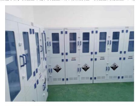
无管道通风柜作为一种新型的通风柜产品,在实验室家具中有着举足轻重的作用,作为对实验室通风系统的补充,在选择合适的产品上面又有哪些需要注意的要点呢?确定购买尺寸:通风柜尺寸太大造成浪费,尺寸过小亦会影响使用,因此老师们在购买通风柜前,要根据实验室情况及实验时素使用的化学品及容器,仪器等选择合适的外形尺寸。一般来说无管道通风柜的内部尺寸跟外部尺寸相差无几,比如一般外排通风柜使用1.8米,那么无管道通风柜采购1.6米即可满足内部使用面积,这样既能节省实验室占用面积,也能节省设备采购成本。实验室试剂柜生产厂家全钢通风柜虽然也防酸碱耐腐蚀,但是跟PP通风柜相比确实差些。
